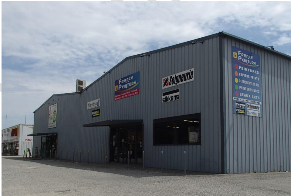
Surface cumulée d'enseignes respectant les 15 % prévus par le règlement national. Le calcul se fait par façade indépendamment l'une de l'autre.
